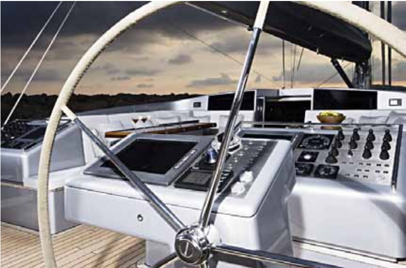
Steuerstand: sämtliches Gerät zum Segeln auf zwei Steuerstände verteilt.
